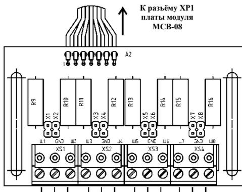
**Рисунок 3 - Внешний вид модуля МШ-08**
