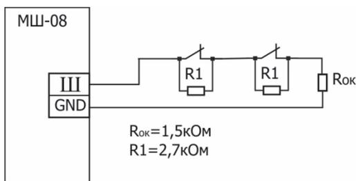
Рисунок Б.2 - Схема подключения шлейфа на четыре состояния.
