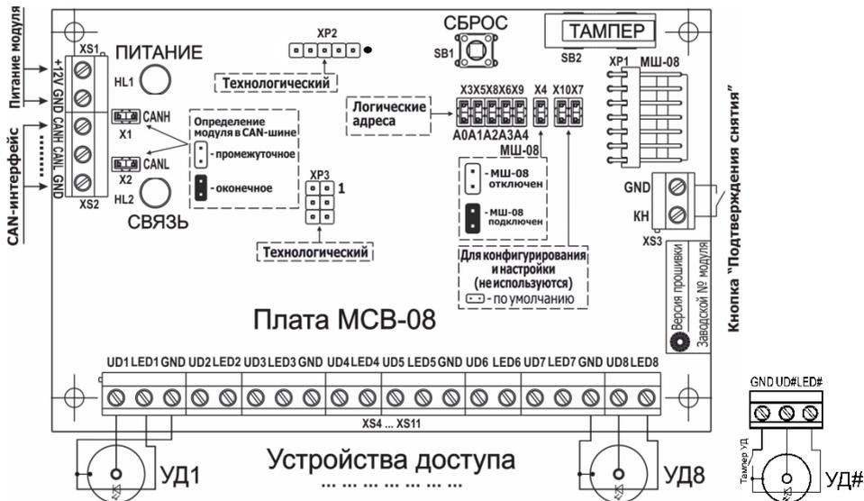
Рисунок 2 - Внешний вид платы МСВ-08 и схема подключений
