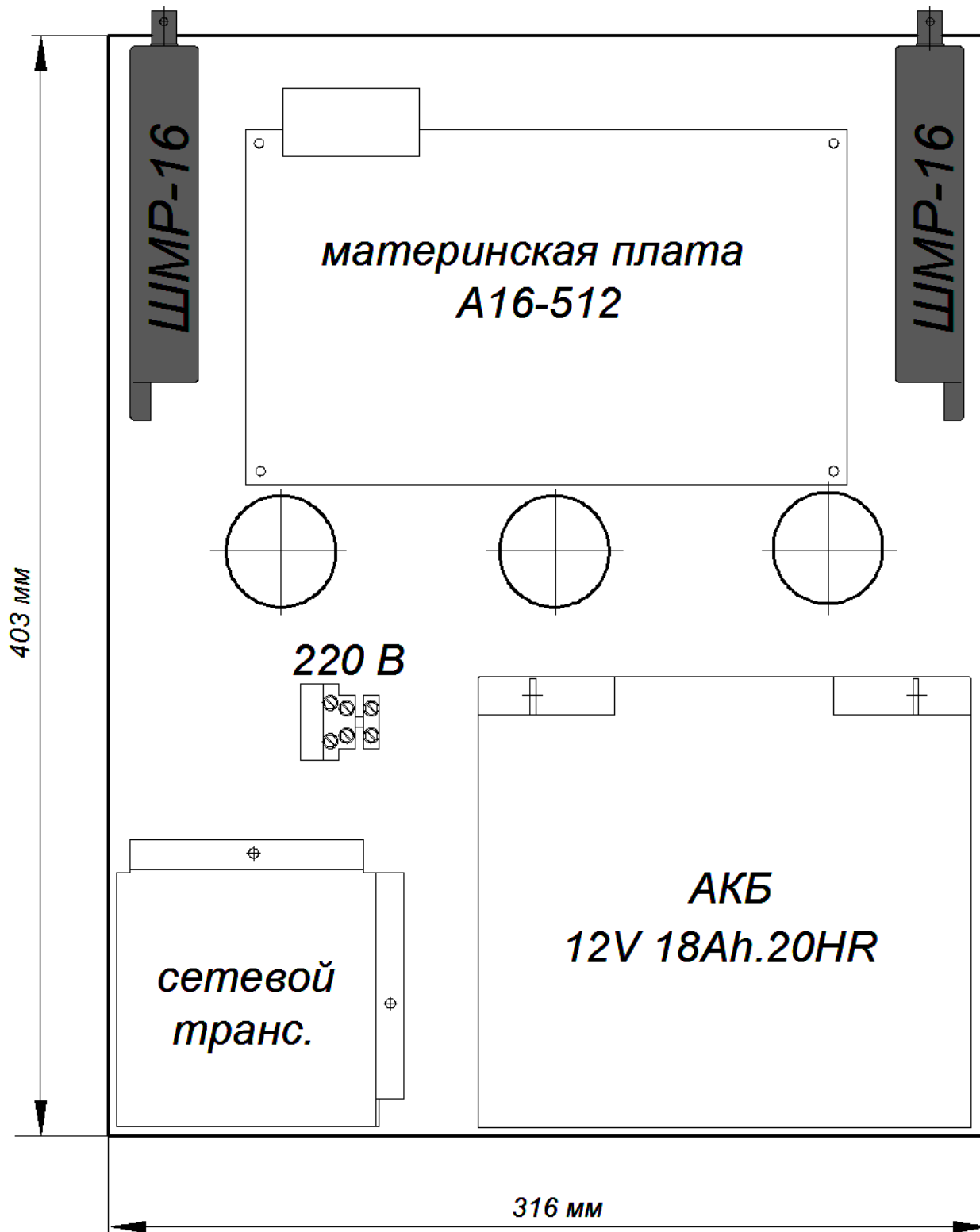
Рисунок 3 – Варианты установки коммутатора ШМР-16 (корпус выпускается начиная с 2012 года)
