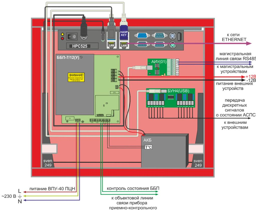
Рис.1. Устройство ВПУ-40 ПЦН
