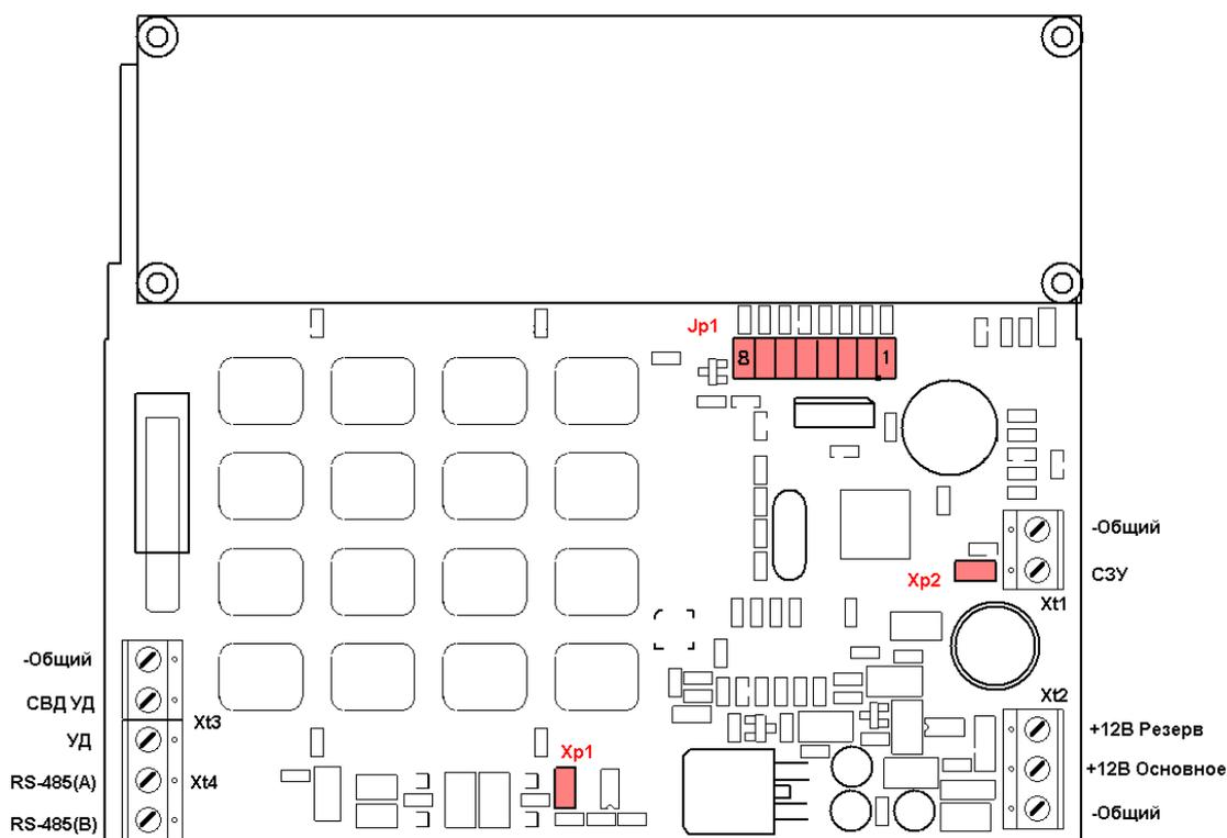
Рисунок 11 – Схема подключения ВПУ
