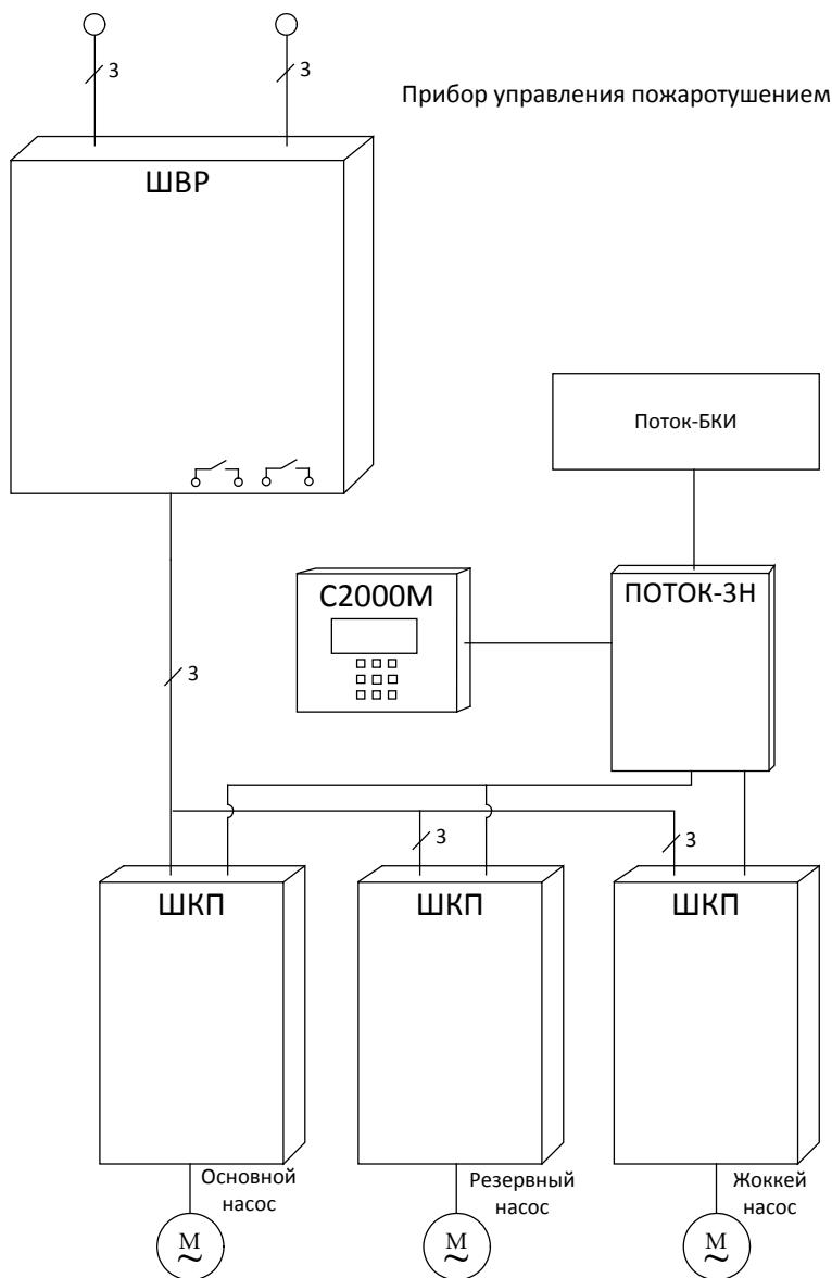
**Рисунок 1.** Схема питания ШКП в составе ППУ.
